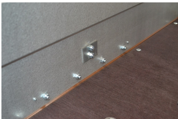
Pohled z vnitřní strany bočnice na uchycení plechu a horního držáku heveru
