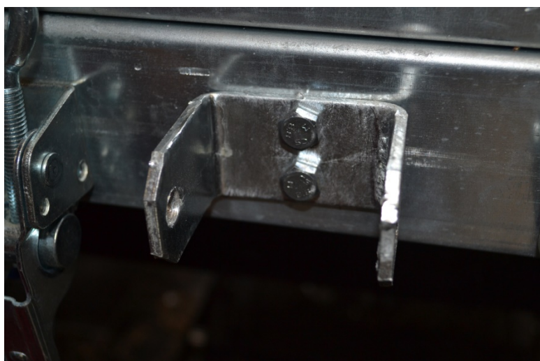
Pohled z vnitřní strany bočnice na uchycení plechu a horního držáku heveru
